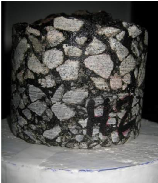
Figur 10. Exempel på asfaltprovkropp före testning.
